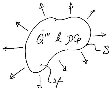
$$\dot{Q}_{in} - \dot{Q}_{out} + \dot{Q}_{gen} = \dot{Q}_{st}$$
